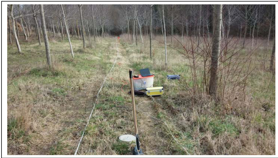
Foto n.1 : stendimento sismico di tipo M.A.S.W.
